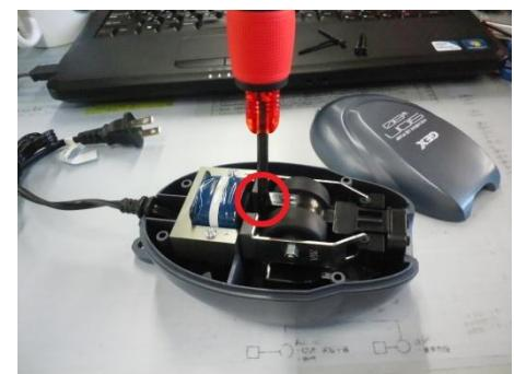
6. ネジを外したら磁石のついている部品を外します。これからこの部品を「台座」と呼びます。
