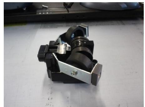
10. 腕を更に広げます。丸い部品の中心にネジが見えます。これをドライバーで外します。
