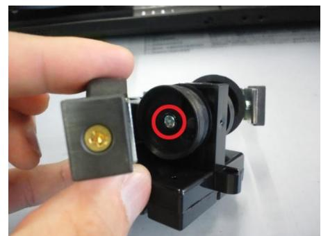
11. ネジを外していくと反対側の部品も取れます。これからこの部品を円盤と呼びます。
