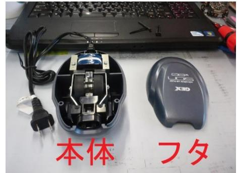
5. 本体の中心部のネジを外します。ネジの両側に磁石がありますので注意して下さい。
